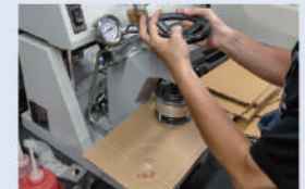
紙箱、紙板耐破強度測試 Carton strength tests
