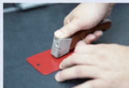
百格測試 Grid knife test
